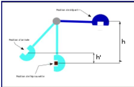
Représentation du mouton-pendule et des hauteurs à prendre en compte pour le calcul de l'énergie absorbée.
