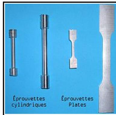
L'éprouvette est tenue en deux points (par une pince ou un crochet), reliés à des filins. L'éprouvette est alors étirée à vitesse constante, et on relève la force de traction nécessaire en fonction de l'allongement. Ces essais permettent de tracer une courbe dite de traction à partir de laquelle les caractéristiques suivantes peuvent être déduites :
