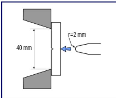
Position de l'éprouvette au moment de l'impact avec le couteau du pendule.
