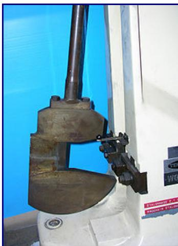
Gros plan sur le couteau et le porte éprouvette d'un mouton Charpy.
